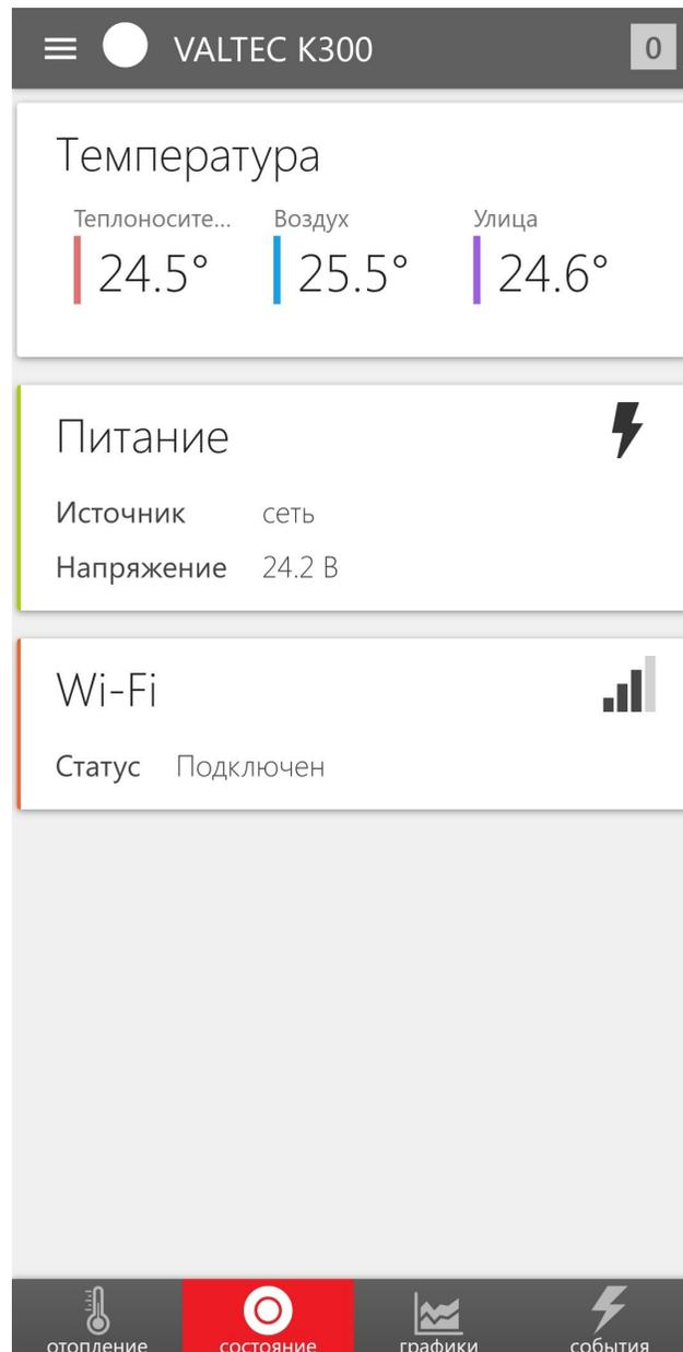
Вкладка «Состояние» содержит информацию о статусе подключения к Wi-Fi-сети, уровне сигнала, текущем напряжении питания котроллера, индикацию показаний температуры со всех датчиков.
