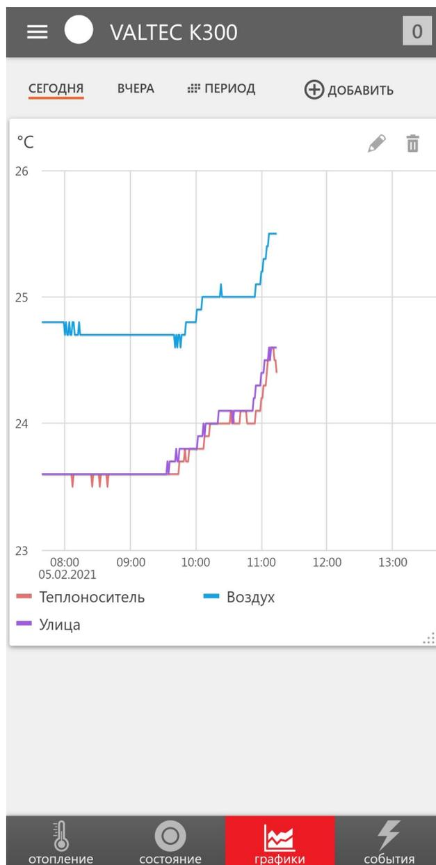
На вкладке «Графики» представлена возможность графического отображения изменения температур за выбранный временной период. Доступна возможность масштабирования экрана.
