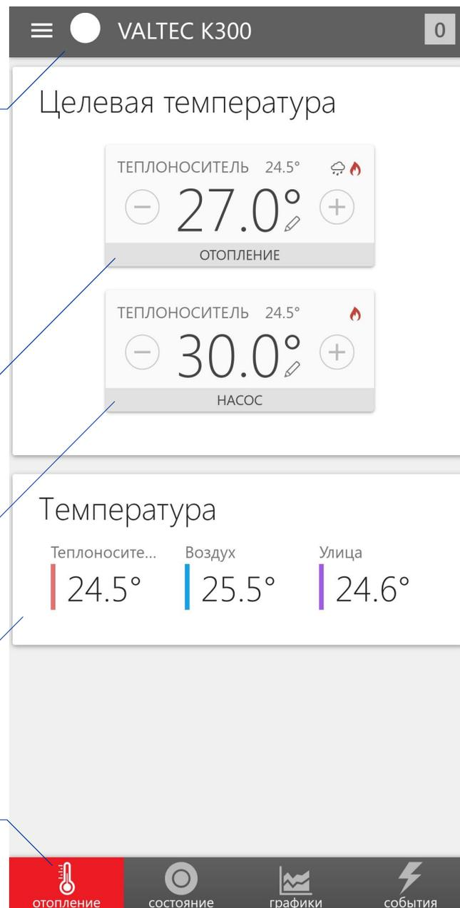
Данная вкладка содержит поля для ручной регулировки целевых температур теплоносителя или воздуха (в зависимости от выбранного при настройке типа регулирования) и включения / отключения циркуляционного насоса, а также индикацию показаний со всех датчиков.
