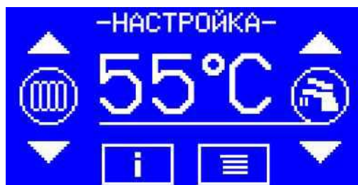
УСТАНОВКА ТРЕБУЕМОГО ЗНАЧЕНИЯ ТЕМПЕРАТУРЫ ГВС
