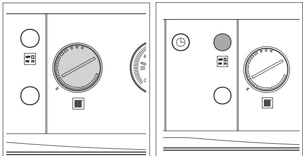
Проверить полное выключение котла, установив общий выключатель системы в положение «выключено».
