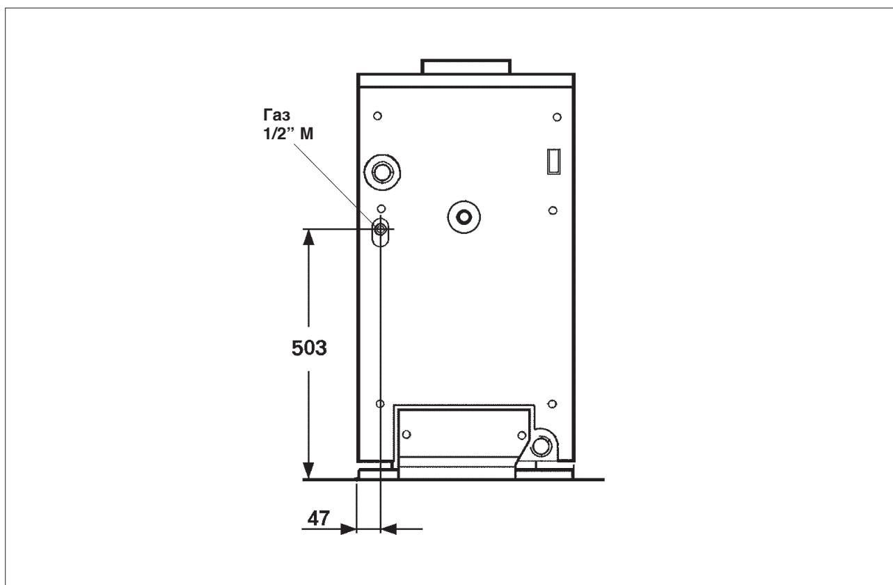
**⚠** Система подачи газа должна соответствовать мощности котла и иметь все предохранительные устройства, предусмотренные действующими нормами и правилами.
