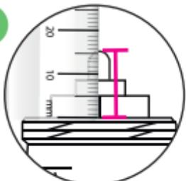
Измерьте высоту штока клапана от основания в открытом положении (должно быть 13-15мм для TRV10RFM и 10-11мм для TRV28RFM).
