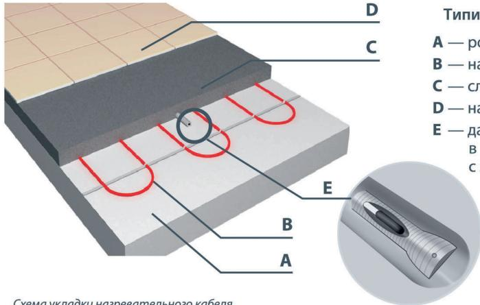
Типичная конструкция пола:
