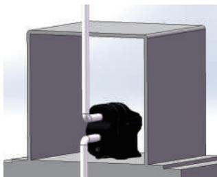
Насос должен быть установлен в удобном для обслуживания месте. Оптимальная установка насоса изображена на рисунке.
