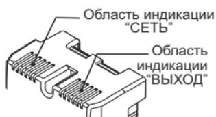
В диапазоне входных напряжений от 165–5В до 260–5В, при правильной фазировке и отсутствии напряжения между «Землей» и «Нулем», индикатор «СЕТЬ» горит непрерывно, если же входное напряжение меньше 165–5В или больше 260–5В, индикатор «СЕТЬ» начинает мигать 1 раз в секунду.
