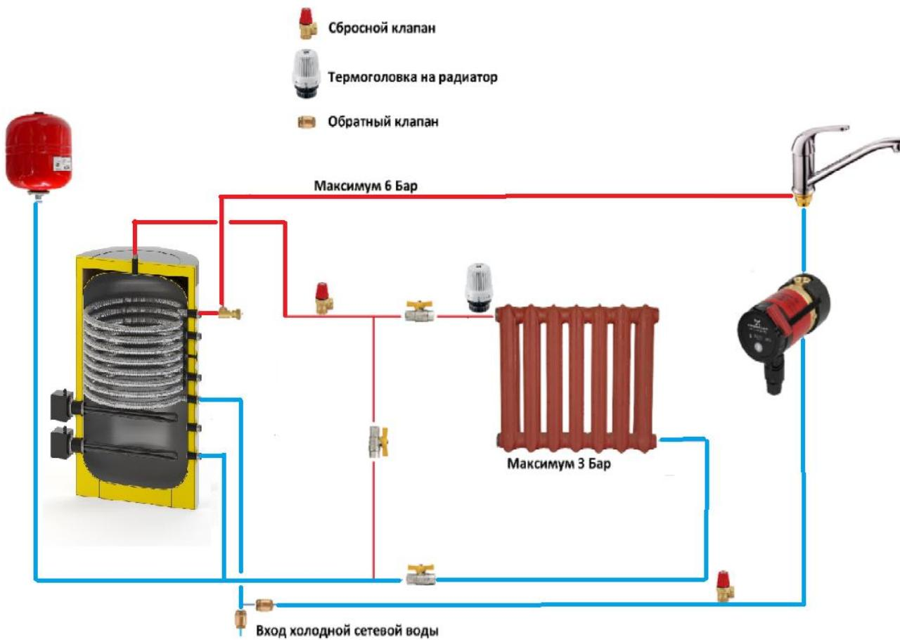
Схема с противоожоговым клапоном и рециркуляцией бака
