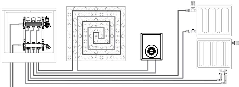
Коллекторная группа не должна испытывать нагрузок от трубопровода (изгиб, сжатие, растяжение, кручение, перекосы, вибрация, несоосность патрубков, неравномерность затяжки крепежа).
