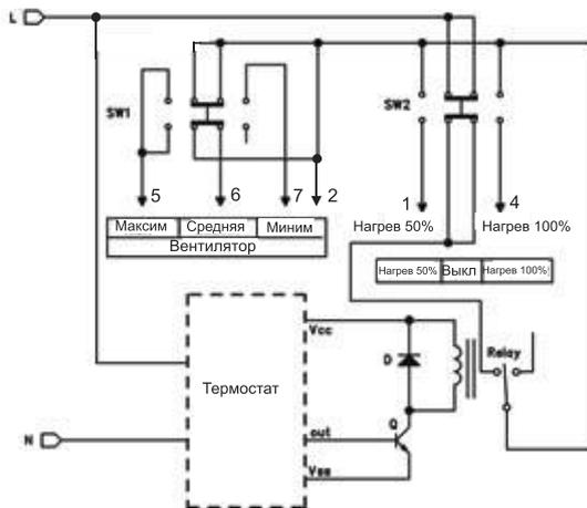
Электрическая схема пультов управления и коммутации ПКУ-E и ПКУ-W
