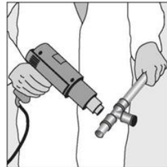
Нагрев демонтируемого соединения
