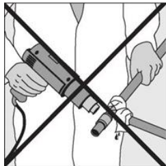
Недопустимо! Нагрев соединения без отсоединения от сети.
