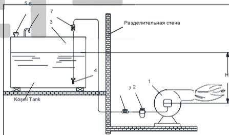
**Топливная емкость ниже горелки;**
