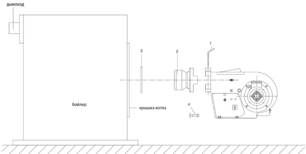
Факельный ствол и узел завихрения топлива (2), уплотнительная прокладка (3) крепится 4-мя болтами (4) к котлу. Горелка соединяется фланцем и фиксируется шпильками (1).
