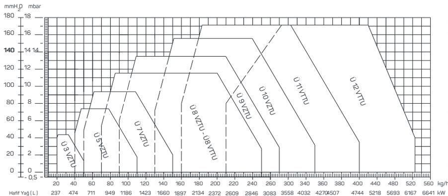
Определяемые на кривых показатели показывают ориентировочное количество сжигаемого топлива в камере сгорания в соответствии с типами горелок и зависят от давления в камере сгорания в условиях работы в обычном режиме. Количество топлива, сжигаемого в горелке, определяется фактическими замерами, выполняемыми на установленном объекте в соответствии с конфигурацией камеры сгорания отопительных котлов и теплообменников и типа дымоходной трубы.
