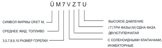
Код "М" для горелок на среднем жидком топливе. Горелки на легком жидком топливе кодом "М" не маркируются.
