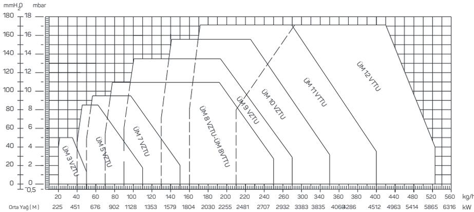
Определяемые на кривых показатели показывают ориентировочное количество сжигаемого топлива в камере сгорания в соответствии с типами горелок и зависят от давления в камере сгорания в условиях работы в обычном режиме. Количество топлива, сжигаемого в горелке, определяется фактическими замерами, выполняемыми на установленном объекте в соответствии с конфигурацией камеры сгорания отопительных котлов и теплообменников и типа дымоходной трубы.
