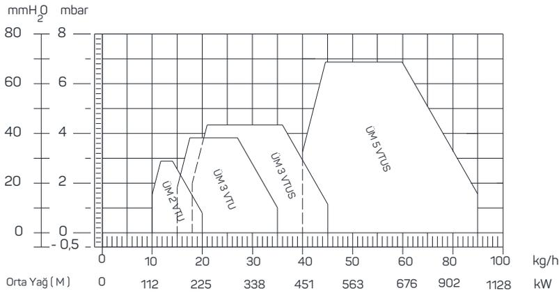
Определяемые на кривых показатели показывают ориентировочное количество сжигаемого топлива в камере сгорания в соответствии с типами горелок и зависят от давления в камере сгорания в условиях работы в обычном режиме. Количество топлива, сжигаемого в горелке, определяется фактическими замерами, выполняемыми на установленном объекте в соответствии с конфигурацией камеры сгорания отопительных котлов и теплообменников и типа дымоходной трубы.
