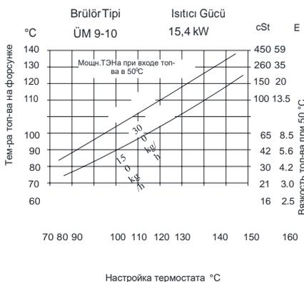
При поступлении среднего жидкого топлива с температурой в 50 °C диаграмма указывает тип подогревателя, желательную вязкость на форсунке и настройку термостата. Здесь вязкость распыления форсунки принята 12 cSt ( 2 E ) .
