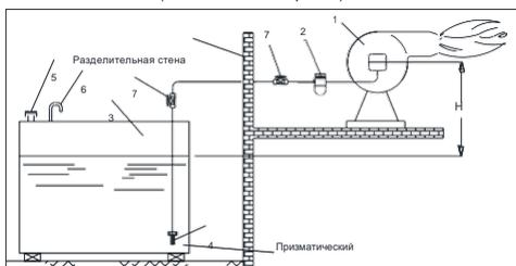
**Топливная емкость ниже горелки;**
