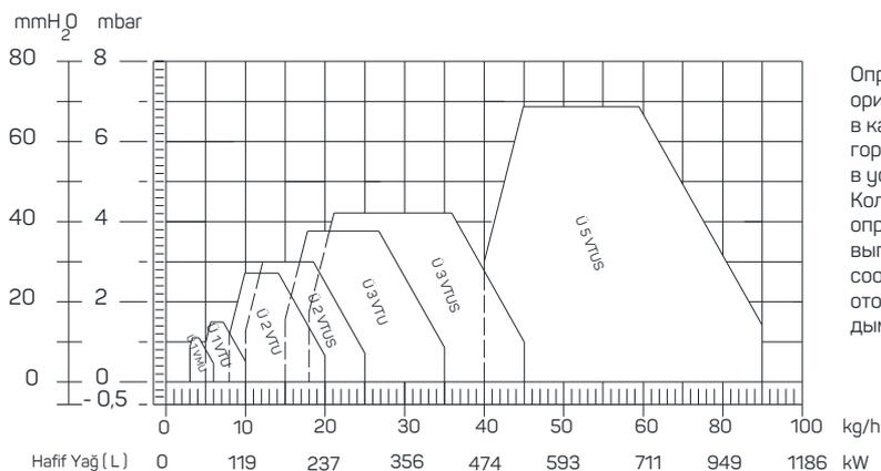
Определяемые на кривых показатели показывают ориентировочное количество сжигаемого топлива в камере сжигания в соответствии с типами горелок и зависят от давления в камере сгорания в условиях работы в обычном режиме. Количество топлива, сжигаемого в горелке, определяется фактическими замерами, выполняемыми на установленном объекте в соответствии с конфигурацией камеры сгорания отопительных котлов и теплообменников и типа дымоходной трубы.
