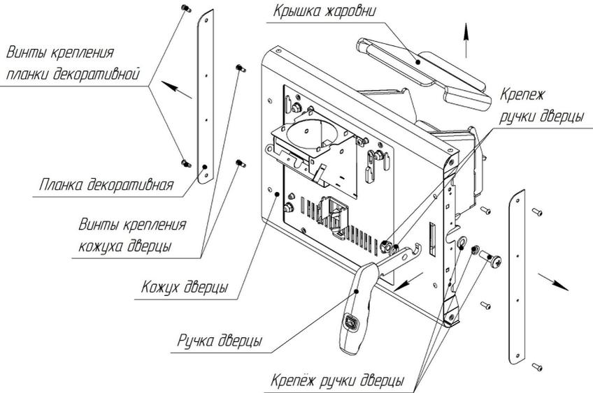
**Рисунок 17 Демонтаж кожуха двери, ручки и крышки жаровни**
