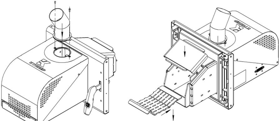
**Рисунок 4. Установка загрузочного патрубка, колосника и крышки жаровни**
