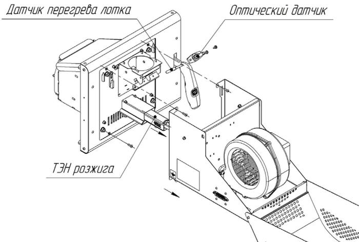
**Рисунок 16 Демонтаж кожуха горелки, датчиков и ТЭНа**
