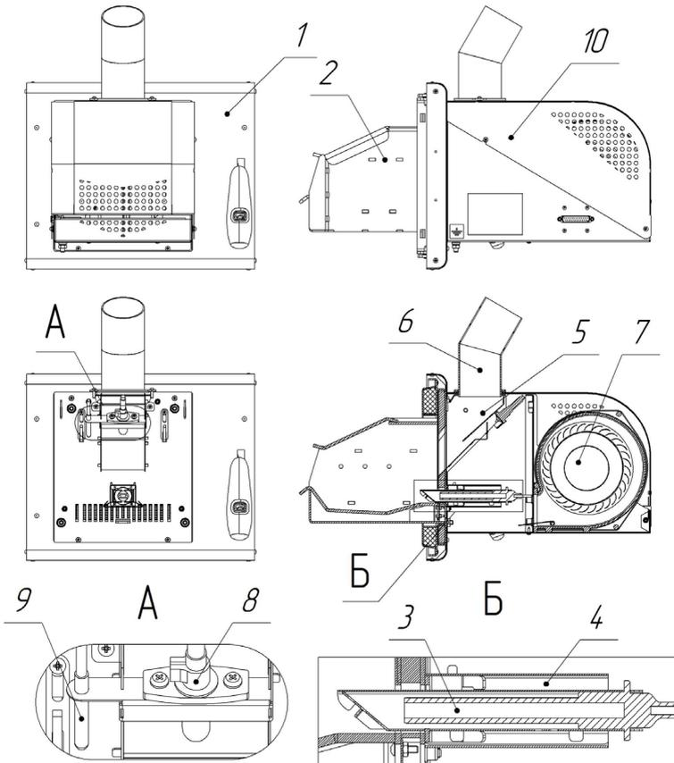
[1] Дверца. [2] Жаровня. [3] ТЭН розжига. [4] Экран ТЭНа розжига. [5] Лоток подачи пеллет. [6] Патрубок подачи. [7] Вентилятор надува. [8] Оптический датчик пламени. [9] Датчик температуры лотка. [10] Кожух защитный.
