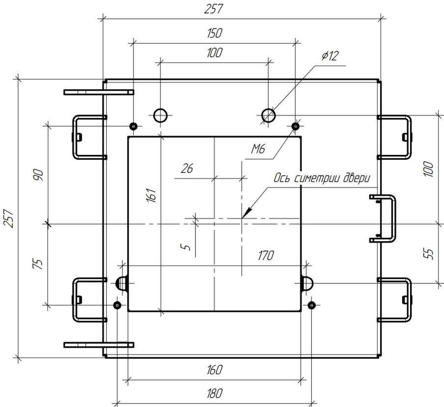
Рисунок 19 Разметка проема и мест крепления ГПФ-26 (3.0)
