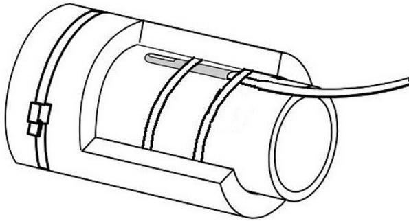
**Рисунок 6 Установка датчика температуры и теплоизолирующей гильзы**
