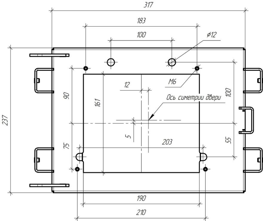
**Рисунок 20** Разметка проема и мест крепления ГПФ-42 (3.0)
