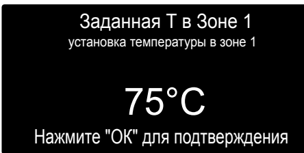
Изменение температуры горячей воды отопления
