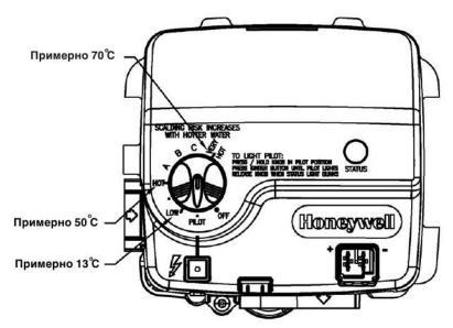
По умолчанию термостат выставлен в положении 0. Обратите внимание, что эксплуатация при низких температурах более экономична. Рекомендуется начинать регулировку водонагревателя с положения «НОТ» на термостате. Поверните ручку по часовой стрелке, чтобы увеличить температуру, и против, чтобы уменьшить.
