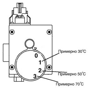
По умолчанию термостат выставлен в положении 0. Обратите внимание, что эксплуатация при низких температурах более экономична. Рекомендуется начинать регулировку температуры с положения 2. Чтобы увеличить температуру, поворачивайте ручку против часовой стрелки, и по часовой стрелке, чтобы уменьшить.
