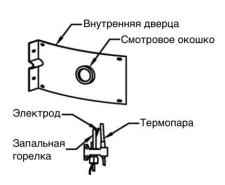
9. Слегка нажмите и удерживайте верхнюю ручку газового клапана. Продолжая удерживать, нажимайте на кнопку пьезорозжига, пока не появится пламя. Продолжайте удерживать ручку газового клапана на протяжении минуты после розжига запальной горелки. Отпустите ручку и убедитесь, что она отскочила. Убедитесь в том, что запальная горелка горит. Если пламя погасло, повторите шаги 2-9.
