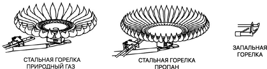
Стальная горелка не снабжена заслонкой для регулирования воздуха. Её нужно просто периодически осматривать, правильно ли она горит. Основная горелка должна плавно загораться от пламени запальной горелки.
