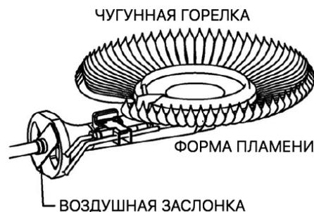
Ослабьте гайку и поверните заслонку, чтобы полностью перекрыть воздух. Затем медленно поворачивайте заслонку, открывая воздух, пока пламя не станет голубым с небольшими жёлтыми кончиками. Затяните гайку. Переизбыток воздуха приводит к отрыву пламени от горелки и шуму. Недостаток воздуха приводит к образованию сажи. Основная горелка должна плавно загораться от пламени запальной горелки.
