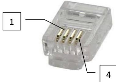
По линиям +12V и GND на устройство поступает питание (7...14В постоянного тока). Линии «А» и «В» представляют собой сигнальные линии интерфейса RS-485. Уровень напряжения при формировании сигнала устройством лежит в диапазоне 0...5В, при формировании сигнала внешним устройством – 0...12В.
