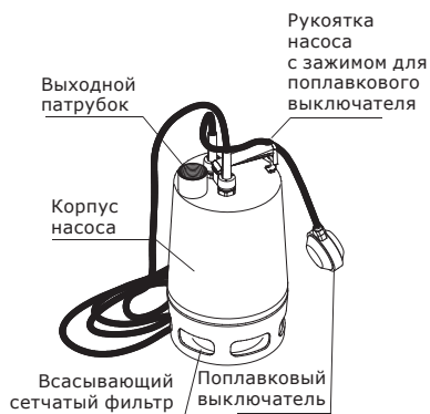
Рис. 1 Конструкция насосов APV.06 / APV.40 V
