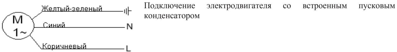
Для подключения используйте водостойкий кабель с поперечным сечением каждой жилы не менее 1,5 мм<sup>2</sup> и с резиновой изоляцией, предназначенный для эксплуатации в питьевой воде (подробнее по длине кабеля (см Таб.3).
