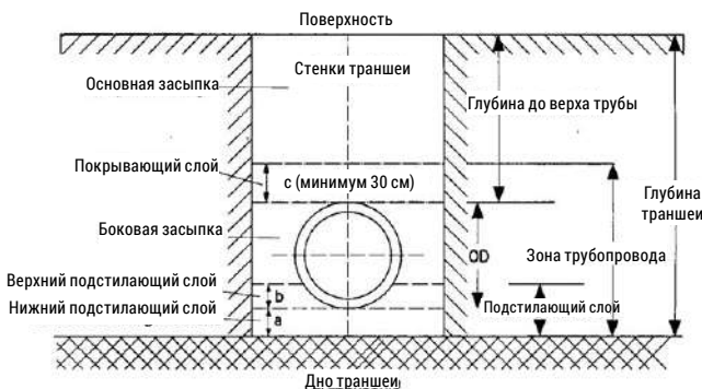
РИС. 3. УСТРОЙСТВО ТРАНШЕИ
