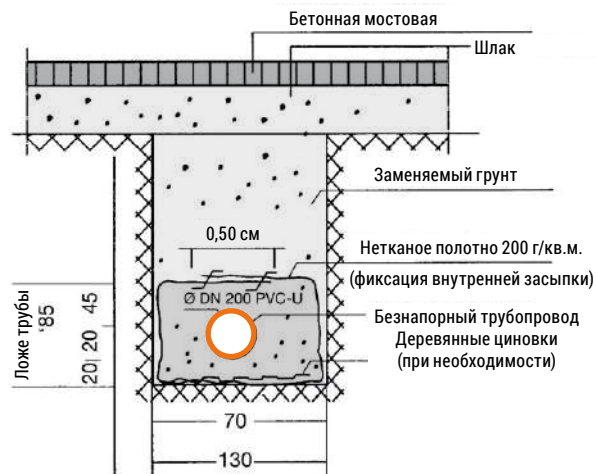
РИС. 7. ПРИМЕР ПРОКЛАДКИ ТРУБ В МЯГКОМ ГРУНТЕ
