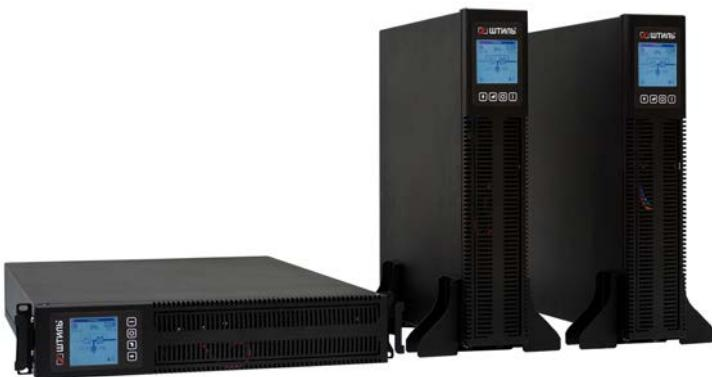
Однофазные ИБП «Штиль» серии STR мощностью от 1 до 3 кВА выполнены по технологии двойного преобразования. Они предназначены для обеспечения бесперебойного питания особо важных потребителей электрической энергии: телекоммуникационного, промышленного и ИТ-оборудования, контрольно-измерительных приборов, систем безопасности и контроля доступа, оборудования АСУ ТП.
