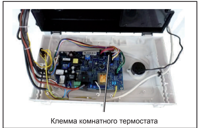
Рис. Подключение комнатного термостата
