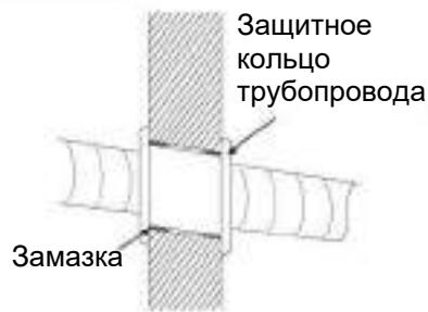
**Примечание.** Обычно отверстие в стене имеет диаметр 60–80 мм. При пробивке отверстий следите за тем, чтобы не повредить скрытую проводку, и избегайте особо прочных и армированных стен.
