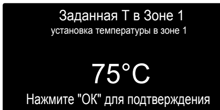
Изменение температуры горячей воды отопления
