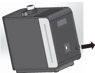
Рис. 9 Разблокировка вала насосной установки AQUAMASTER
