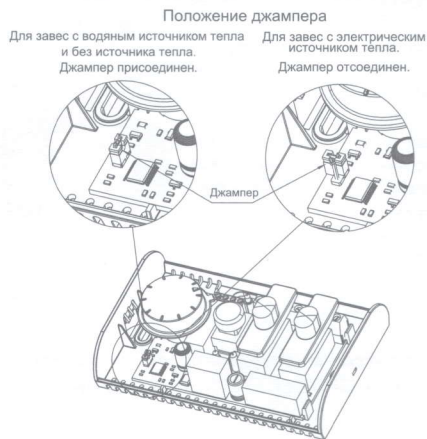
Рис. 8 Установка переключки контроллера KRC - 32.
