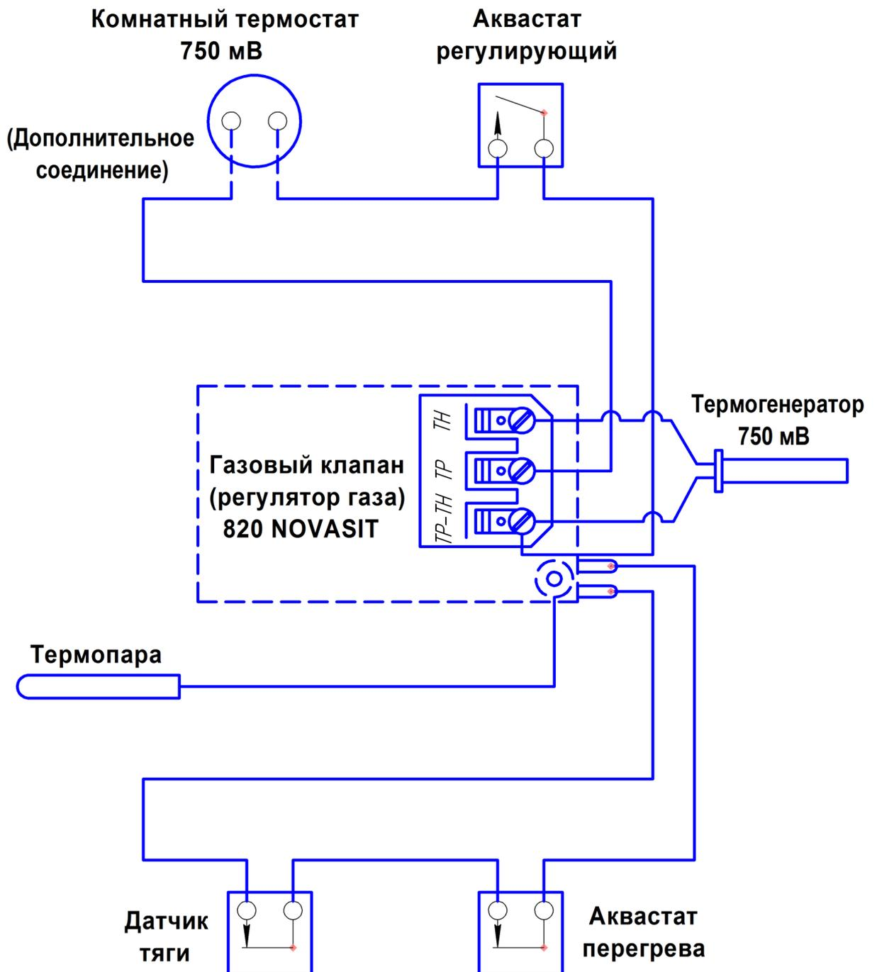
Схема электрических соединений котла
