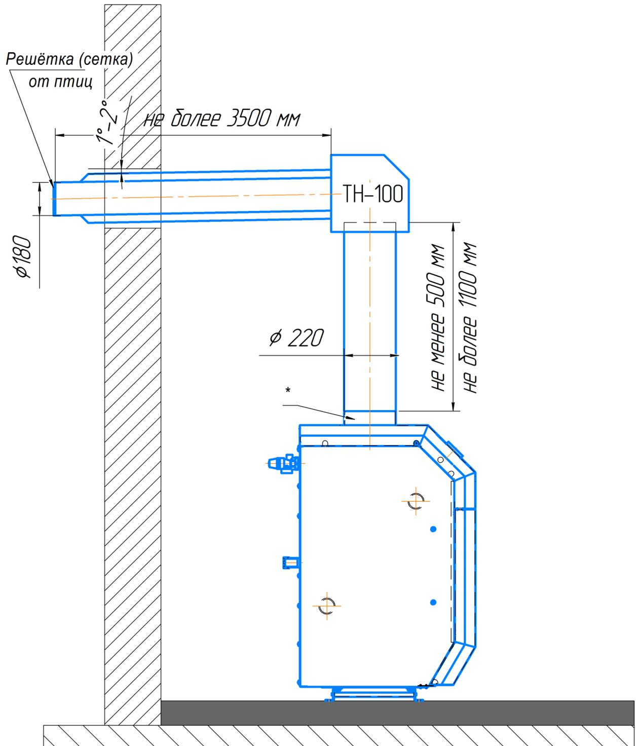
\* Для установки турбонасадки ТН-100 на котёл КОВ - 63 ES использовать переходник с Ø180мм на Ø220 мм.
