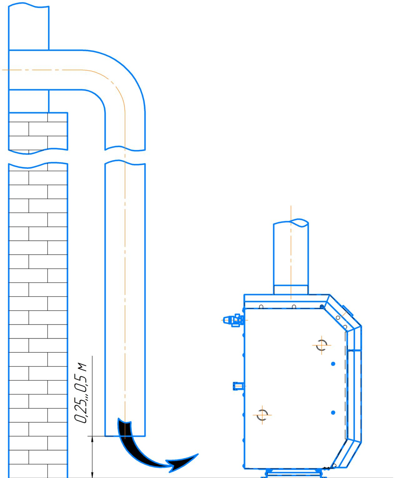
**Рис.8 Подача воздуха в герметично закрытое помещение**
