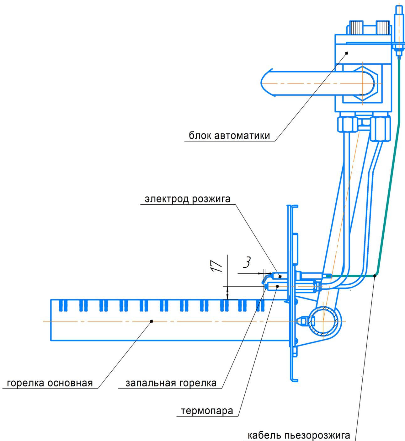
**Рис. 3** Схема расположения запальной горелки относительно основной горелки котла КОВ ES с автоматикой безопасности 810 ELETTROSIT
