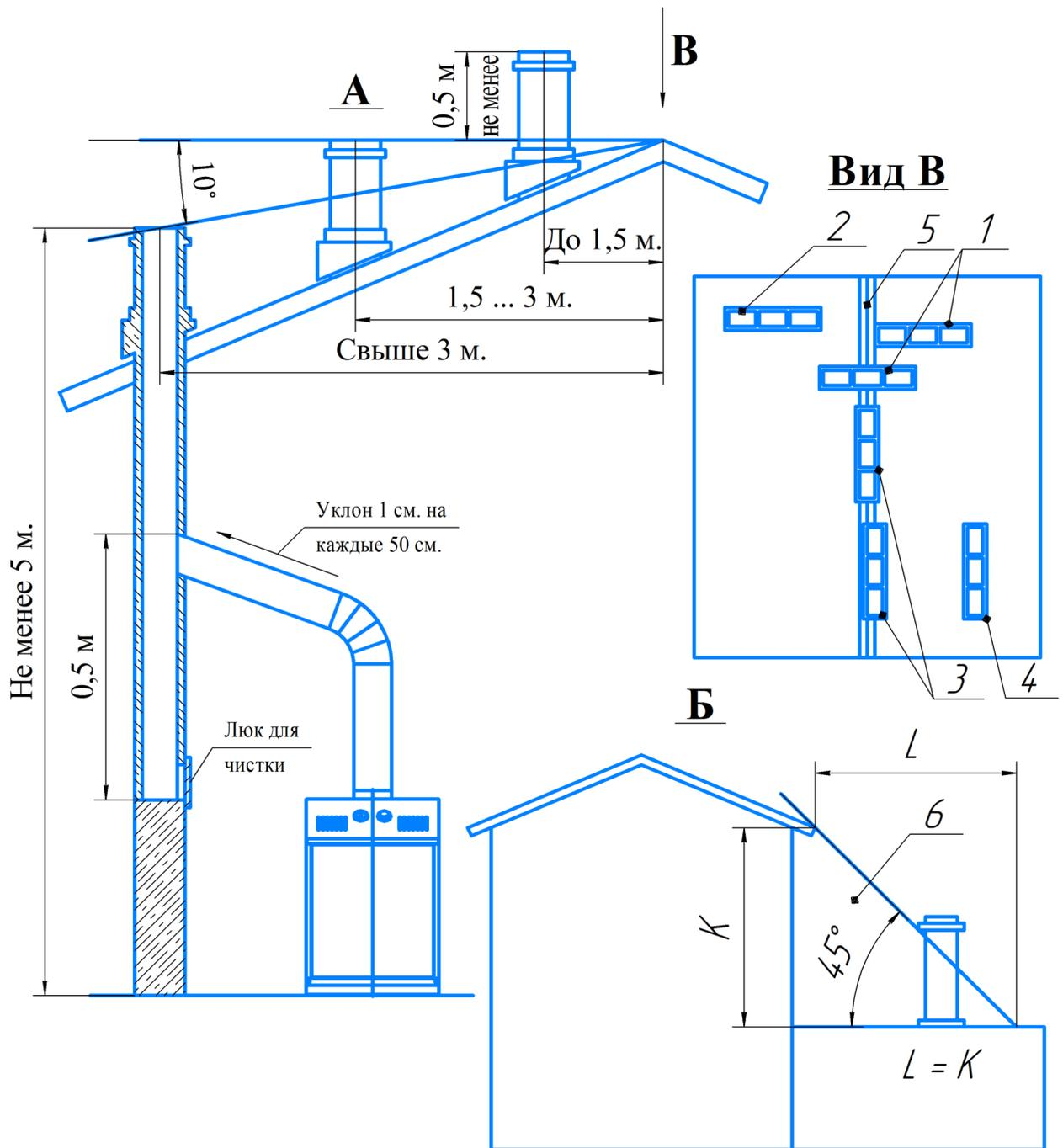
А - положение оголовка дымохода относительно конька крыши.
