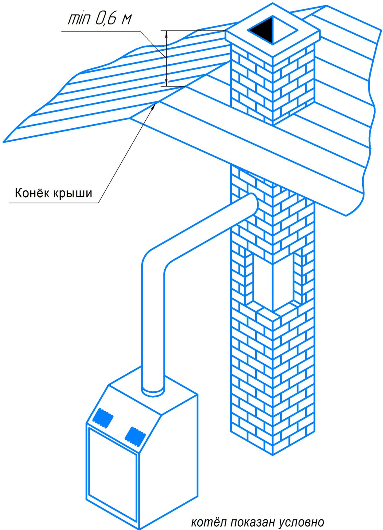
**Рис. 9 Типовой кирпичный дымоход**
