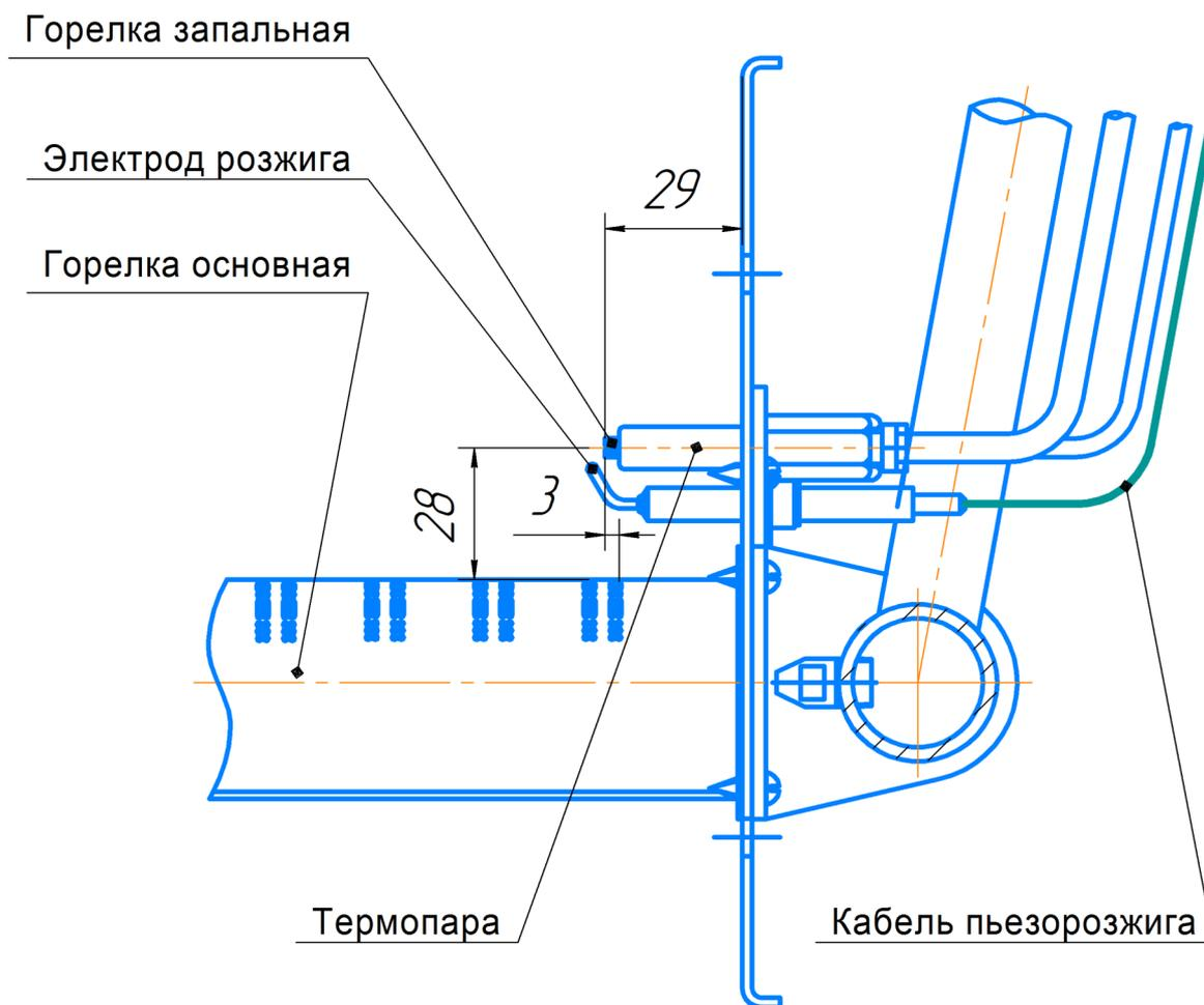
**Рис.3Б Схема расположения горелки запальной относительно основной котла с блоком автоматики 820 NOVASIT**
