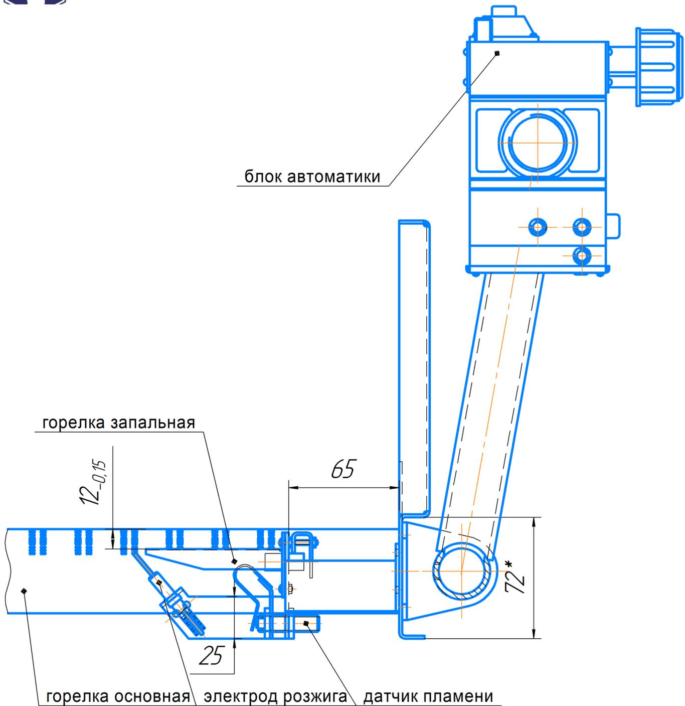
**Рис. 3А Схема расположения запальной горелки относительно основной горелки котла КОВ с автоматикой безопасности САБК-110 М**
