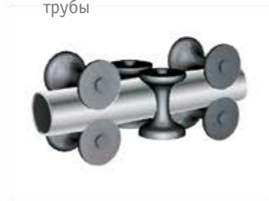
7 Охлаждение, калибровка и правка непрерывной трубы
