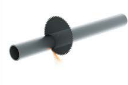
9 Порезка на мерные длины, обрезка концов
