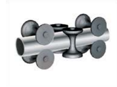
7 Охлаждение, калибровка и правка непрерывной трубы
