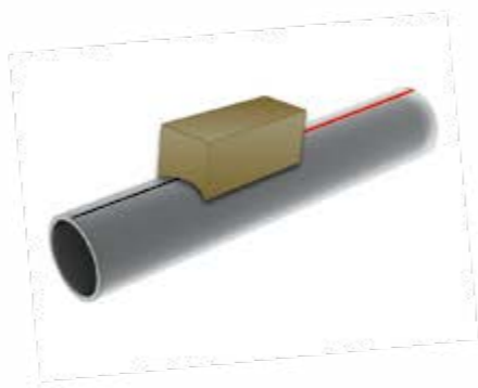
5 Локальная термообработка сварного соединения
