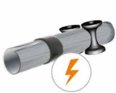
4 Сварка трубной заготовки
