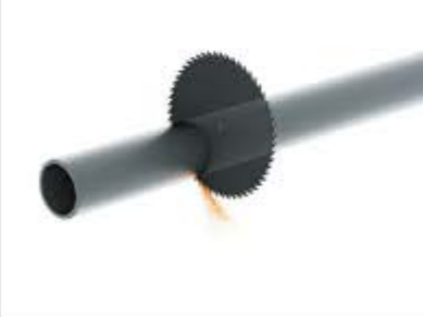
8 Порезка пилами на мерные длины
