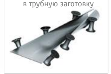
3 Формовка штрипса в трубную заготовку
