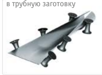
3 Формовка штрипса в трубную заготовку
