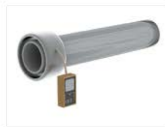
8 Неразрушающий контроль сварного соединения (дефектоскопия)
